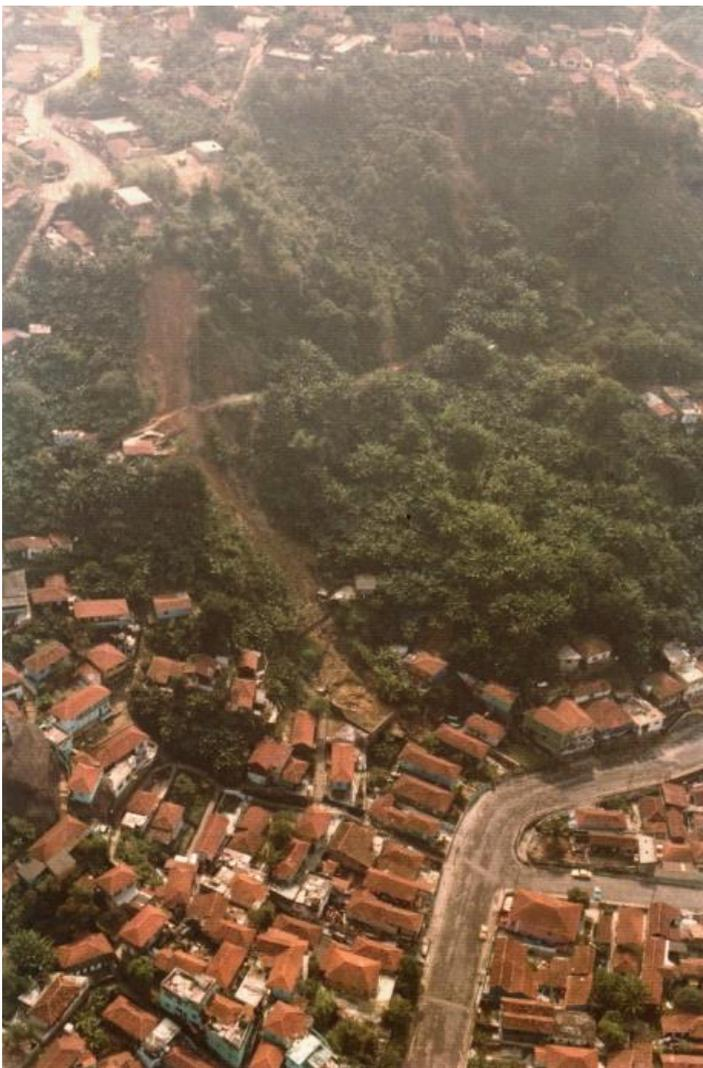
Figura 07. Parte do levantamento do IPT, durante os trabalhos de mapeamento da Carta Geotécnica – Zona de acúmulo de material escorregado no Morro do Jabaquara, em 1978 – Foto: IPT. Fonte: [http://www.ipt.br/institucional/campanhas/16-voce\\_sabia\\_que\\_o\\_ipt\\_elaborou\\_a\\_primeira\\_carta\\_geotecnica\\_do\\_pais\\_.htm](http://www.ipt.br/institucional/campanhas/16-voce_sabia_que_o_ipt_elaborou_a_primeira_carta_geotecnica_do_pais_.htm) acesso em 09 nov. 2016.
