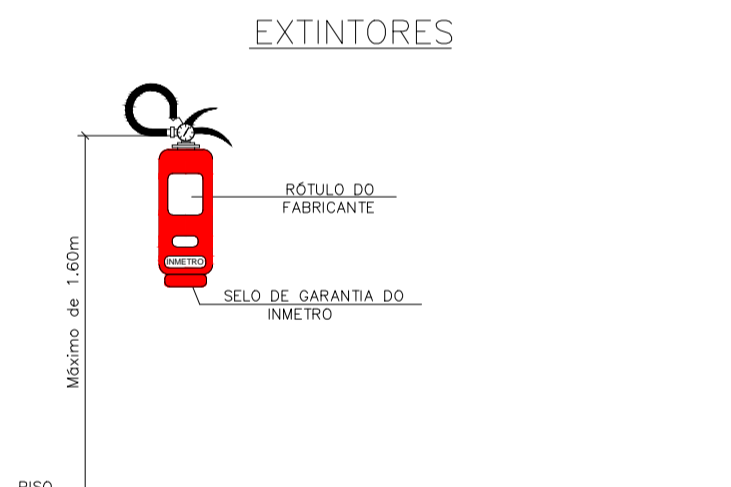
INSTALAÇÃO DOS EXTINTORES DE INCÊNDIO SEM ESCALA
