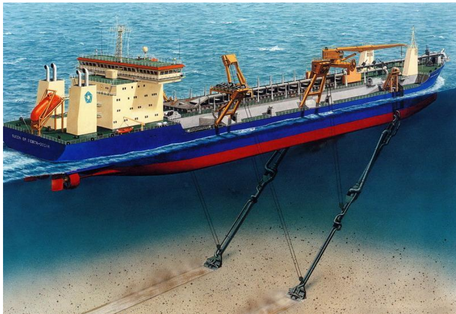
Figura 5.2.4.2-1: Draga do tipo Trailing Suction Hopper Dredger (TSHD) Fonte: Jan de Nul.
