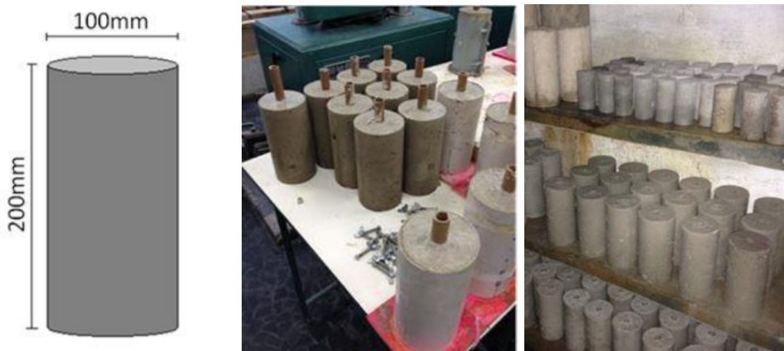
Figura 13.4-1: Dimensões e exemplo do Corpo de Prova. Fonte Andrade, 2016.
