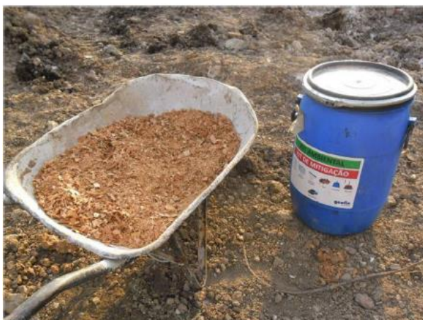
Figura 2.15.4-1: Exemplo de kit de mitigação para derramamentos de óleo.
