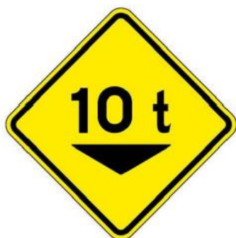
A-46 – Peso bruto total limitado Adverte ao condutor da existência, adiante, de restrição de peso bruto total máximo do veículo. Utilizado sempre que as características da via não permitam o trânsito de veículos com peso bruto total superior ao indicado.
