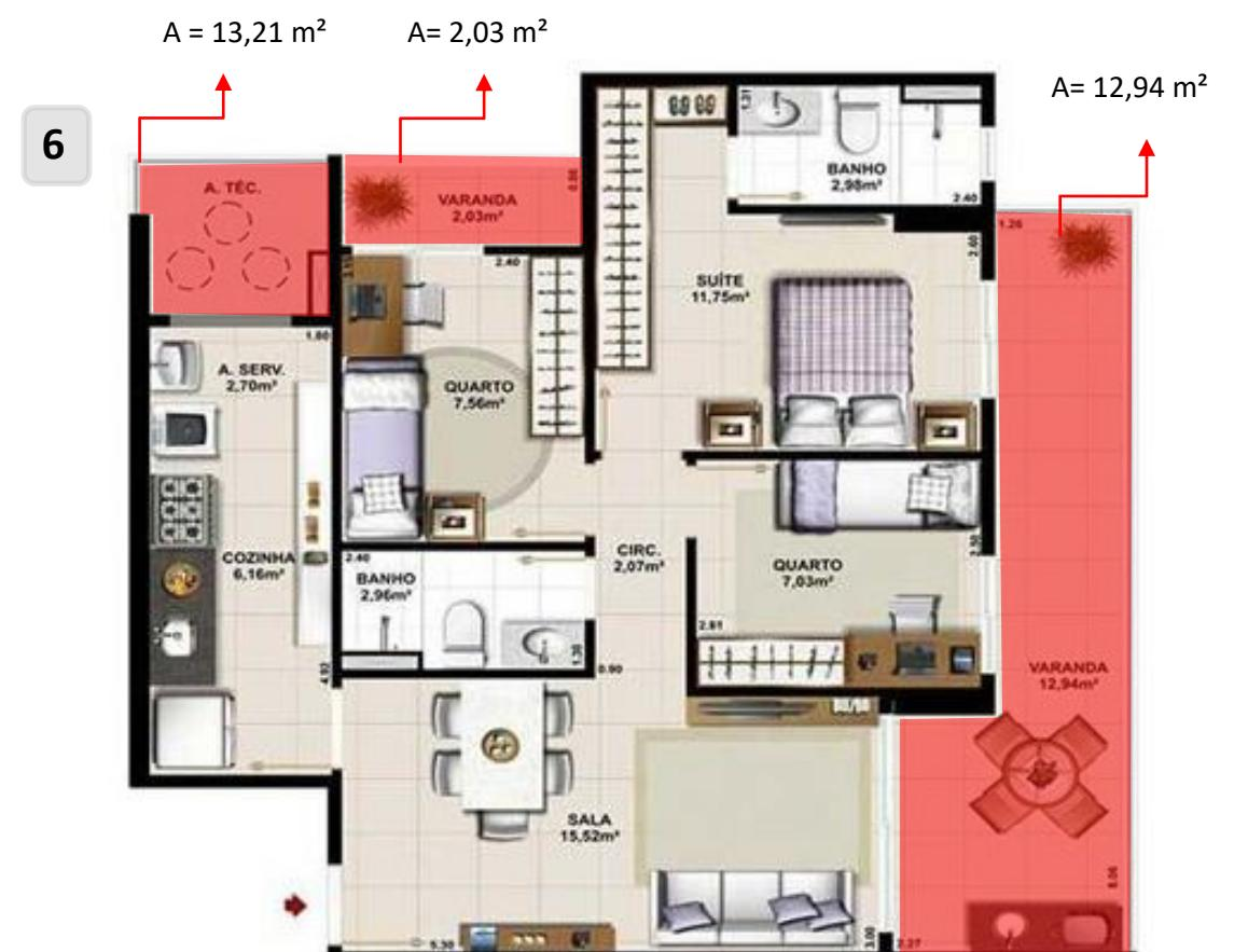
Neste exemplo, a somatória das áreas de varandas (18,18 m<sup>2</sup>) equivale a 23,65% da área total (76,7 m<sup>2</sup>), sendo assim respeita o limite de 25% previsto no art. 55.
