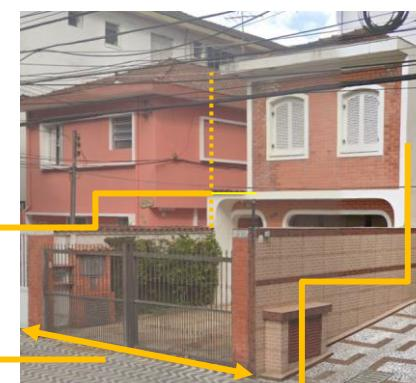
Os acostamentos previstos devem respeitar a altura máxima de 7,50m contados do nível do meio fio até o ponto mais alto de qualquer elemento construtivo que esteja acostado ou a menos de 1,50m desta divisa, sendo permitidos terraços descobertos acima do pavimento térreo, desde que vedados do imóvel vizinho por meio de muro com altura mínima de 2,20m.
