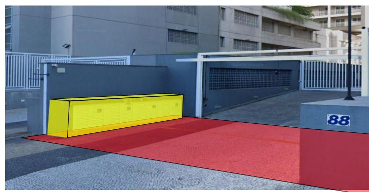
Permitida instalação de medidores no recuo frontal e abrigos de gás, estes últimos acostados nas divisas laterais e com altura máxima de 2,20 m.
