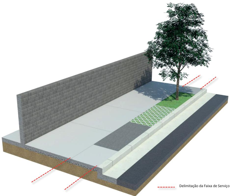
*Cuidado com a inclinação longitudinal, ela deve acompanhar o greide enquanto, a inclinação transversal deve ser constante, não superior a 3%, exceto nas áreas de entrada e saída de veículos!*
