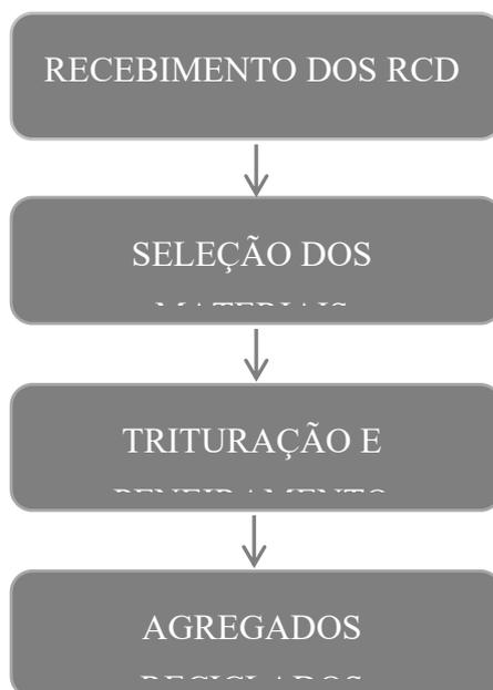
A britagem ou a trituração é a etapa principal do beneficiamento dos RCD, da qual resultam os agregados reciclados. Os RCD podem ser britados uma vez ou mais, dependendo das dimensões e granulometria desejadas para os agregados.
