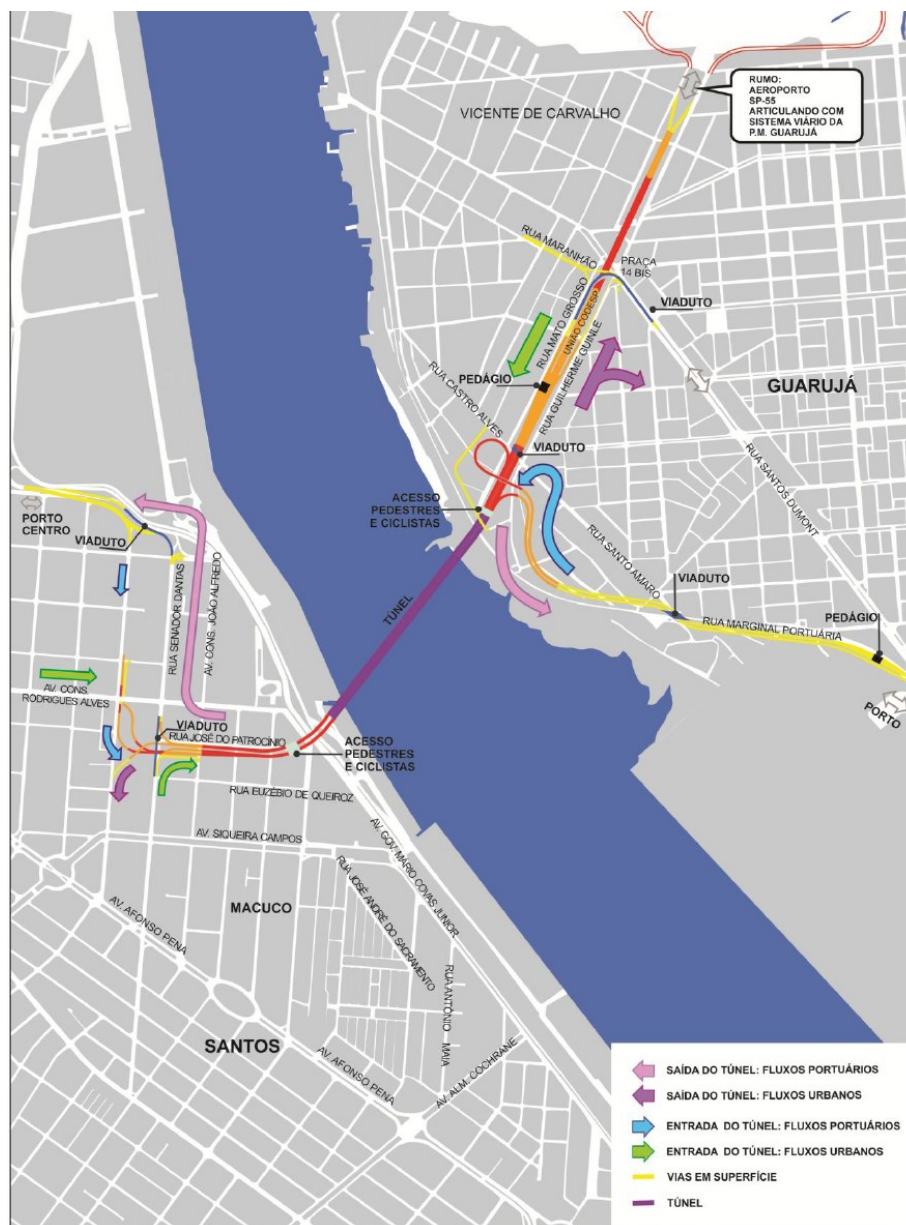
Figura 54. Concepção geral do Túnel Santos-Guarujá.
