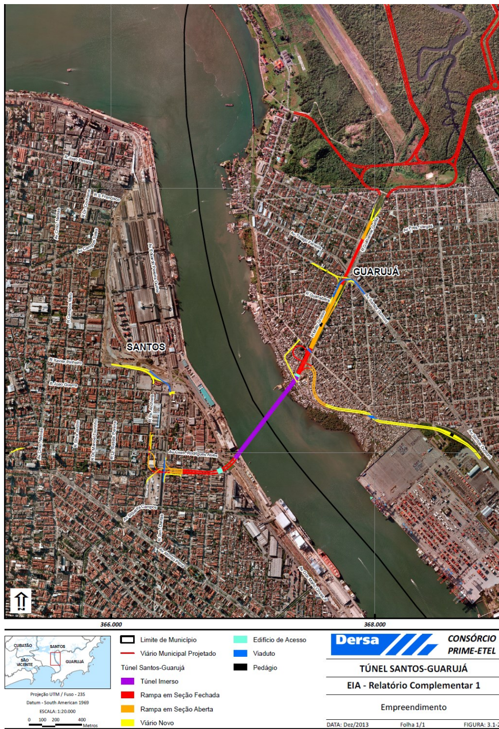
Figura 55. Projeto funcional do Túnel Santos-Guarujá e acessos.
