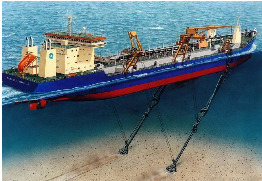
Figura 12 – Imagem extraída do EIA/RIMA com exemplo de embarcação a ser utilizada para a dragagem.
