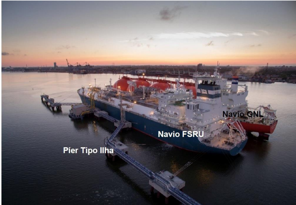
Figura 2 – Imagem extraída do EIA/RIMA com os navios de operação do terminal, e o píer ilha de atracação.
