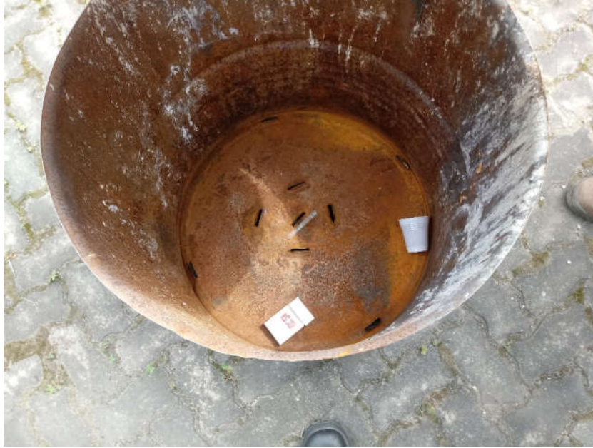
Foto 6.2 – Coletor utilizados contendo furos na base e sobre área não impermeabilizada.
