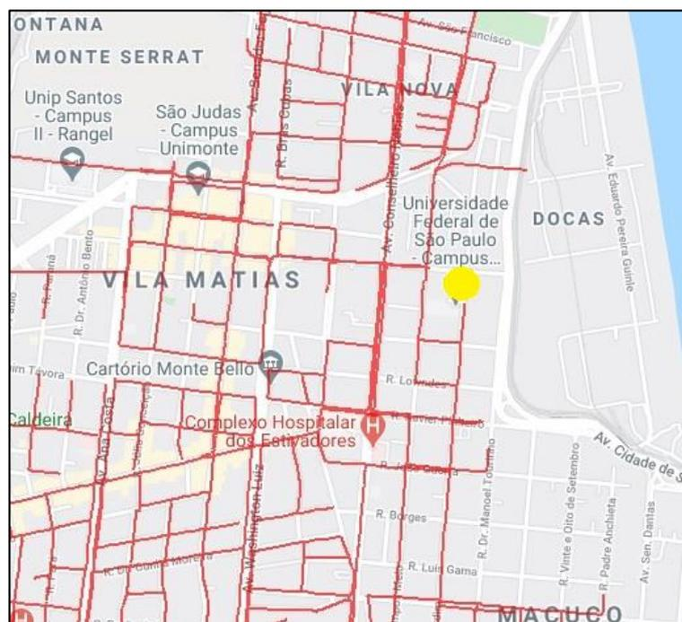
**Figura 10:** Rede de distribuição de gás canalizado
