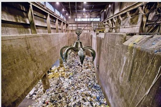
**Foto 1: Exemplo de Fosso de Recebimento com garra hidráulica.**
