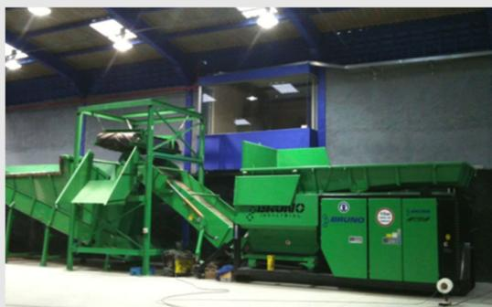
Foto 3: Exemplo de Abridor de Sacos e Extrator Eletromagnético.
