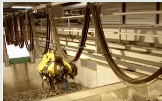
Foto 4: Exemplo de Ponte Rolante com Garra Hidráulica.
