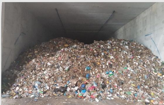
**Foto 5: Exemplo de Bioestabilizador com CDR (resíduo já seco).**
