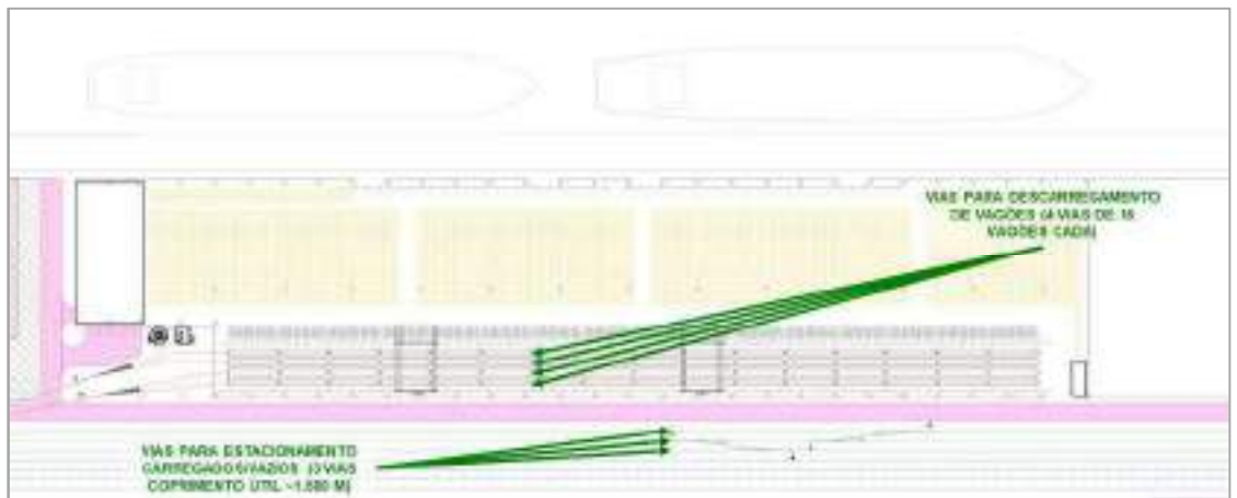
Figura 20 – Esquema do recebimento e posicionamento dos vagões
