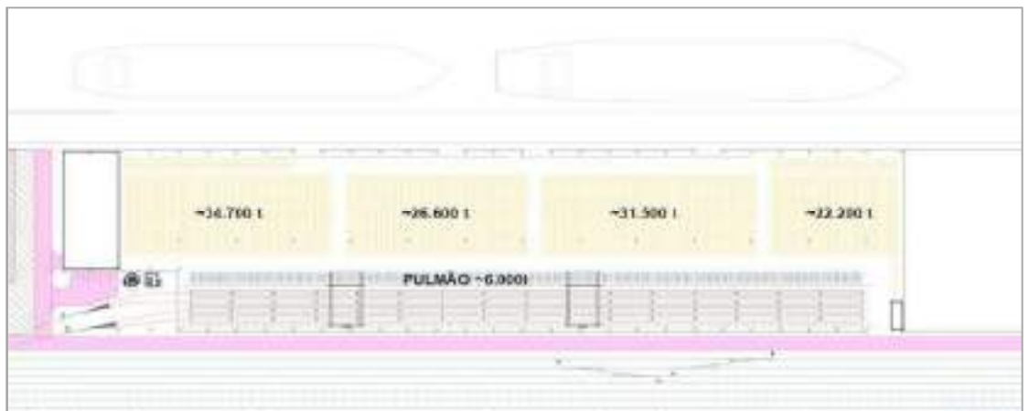
Figura 24 – Estocagem de Celulose – Arranjo Geral
