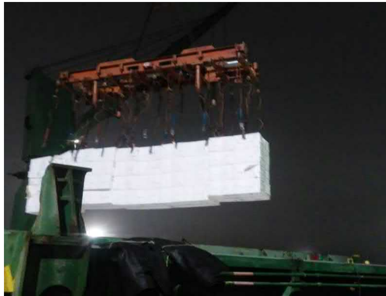
Figura 32 – Carregamento do navio utilizando guindastes ( Jib Crane ).
