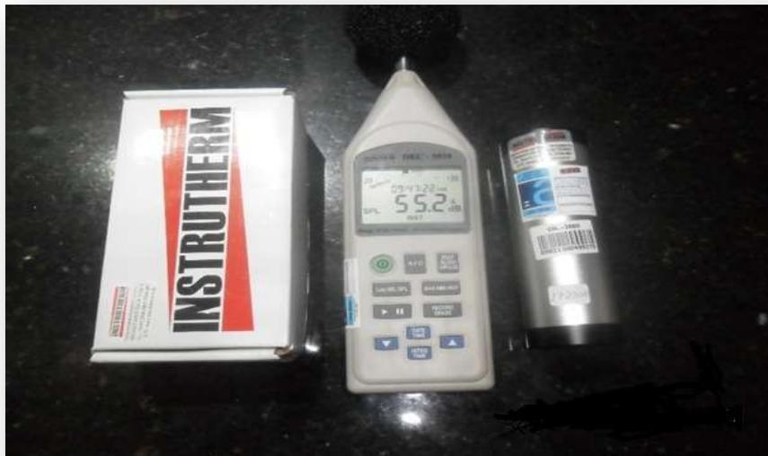
**Figura 24** – Detalhe do Decibélímetro DEC 500 e seu respectivo calibrador CAL 3000 - IEC942.
