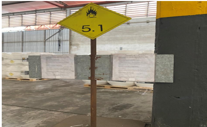
Foto 2.2.2-6: Segregação e identificação do risco dos produtos químicos armazenados - símbolo de risco NBR 7500 – Identificação para o transporte terrestre, manuseio, movimentação e armazenamento de produtos.
