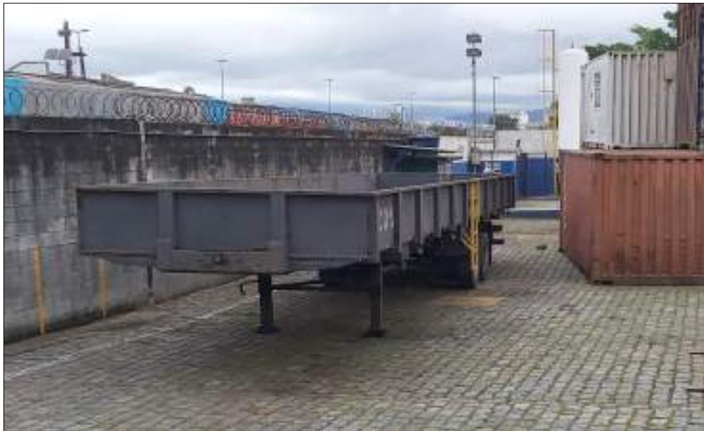
Figura 102 – Tanque móvel para contenção de vazamentos internos de contêineres.
