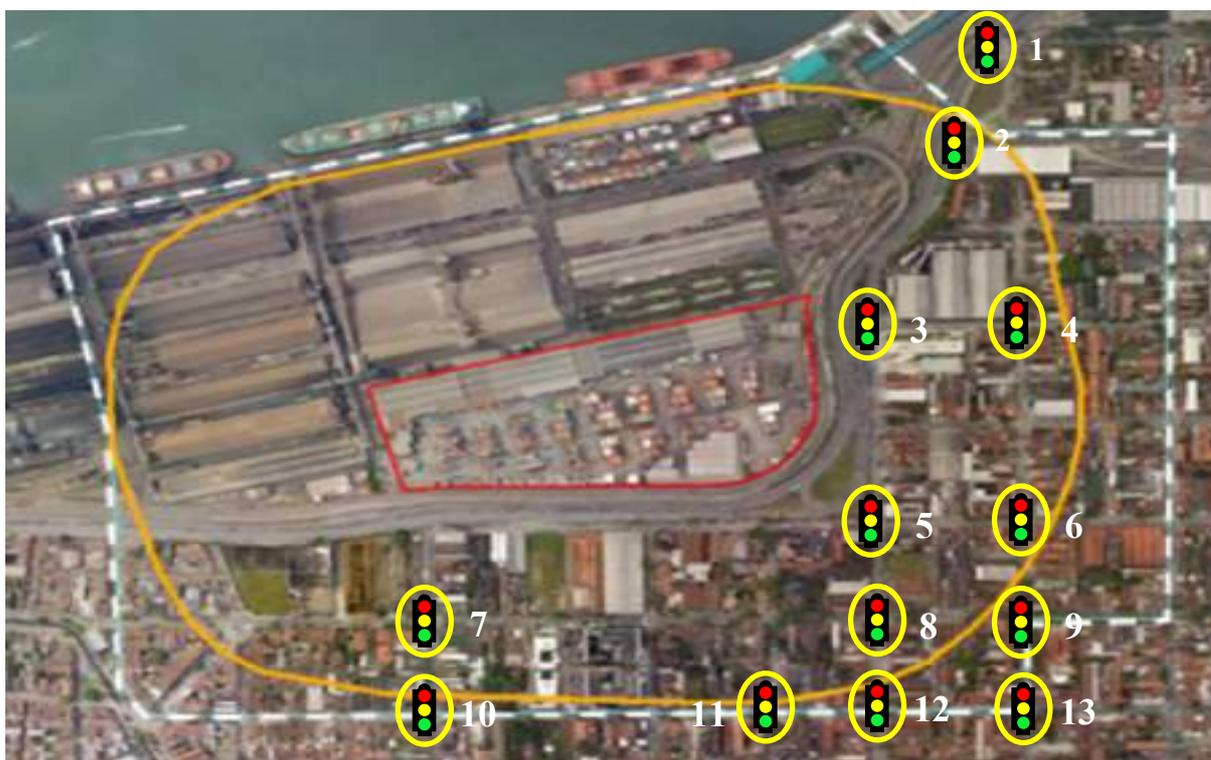
Figura 73 – Equipamentos semafóricos existentes na AID Expandida.
