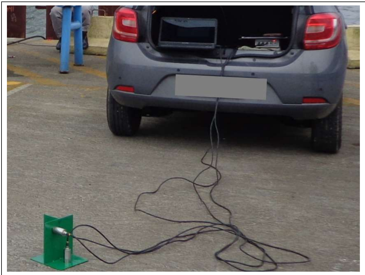
Figura 1: Vista detalhada do sensor de vibrações em três eixos, marca TEKNIKAO
