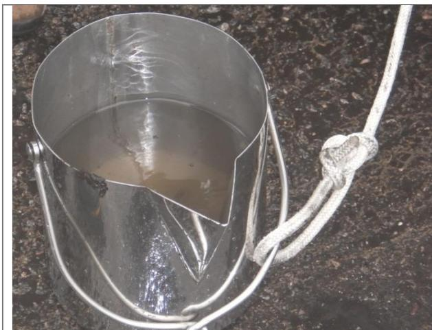
Figura 2.3.1-1. Balde de inox utilizado na amostragem de efluente.
