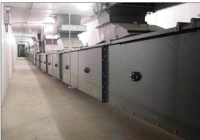
Figura 6.8.2 - 4: Exemplo de correia transportadora enclausurada já implantada no Terminal.
