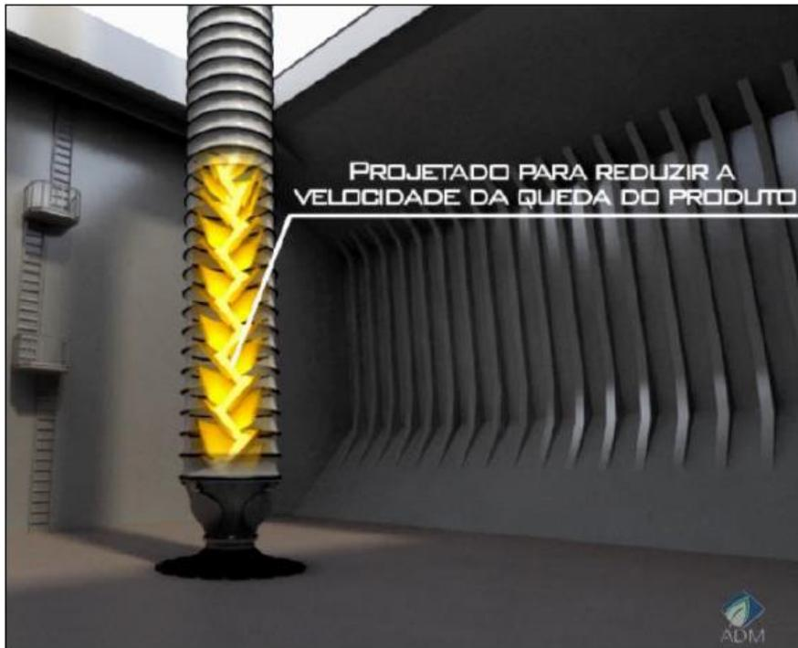
Figura 6.8.2 - 1: Detalhe do tubo telescópico dentro do navio.
