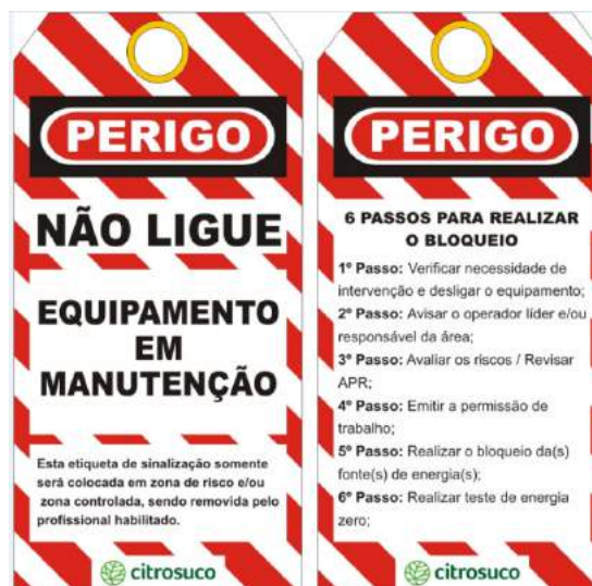
Etiqueta sinalização manutenção elétrica
