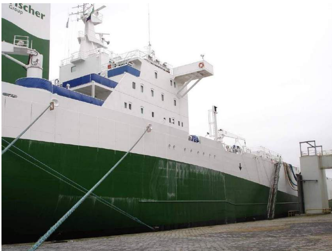
Foto 5 – Navio tanque de suco em manobra de transferência do produto, repare os mangotes flexíveis entre o navio e plataforma de carga.
