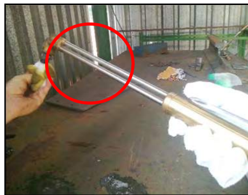
Verificação de vazamento acionando manopla da caneta
