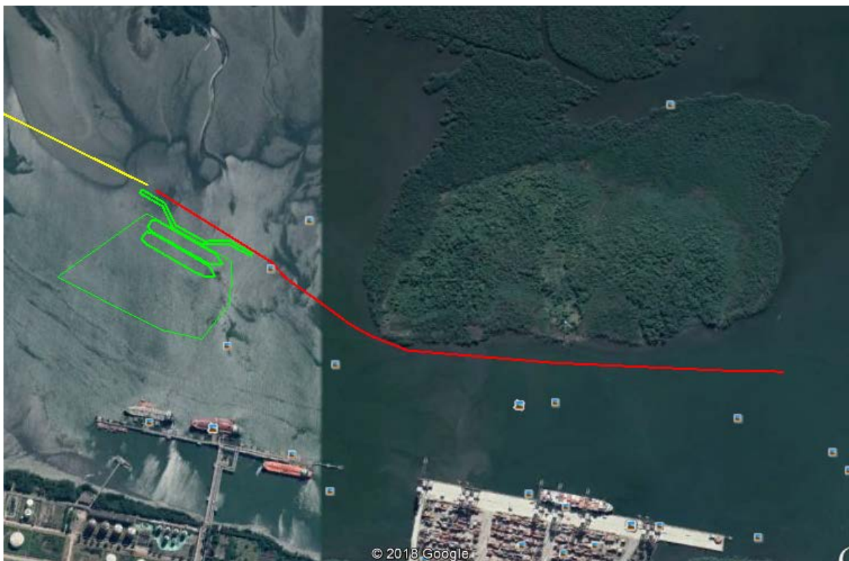
Figura 7.4.8.2-1: Área de montagem de tubulação do gasoduto marítimo
