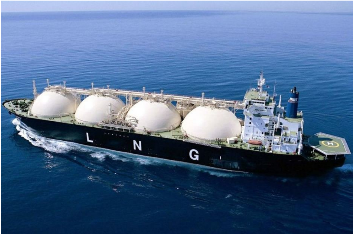
Figura 7.2.3.1-1: Navio carregador de gás natural liquefeito - LNGC
