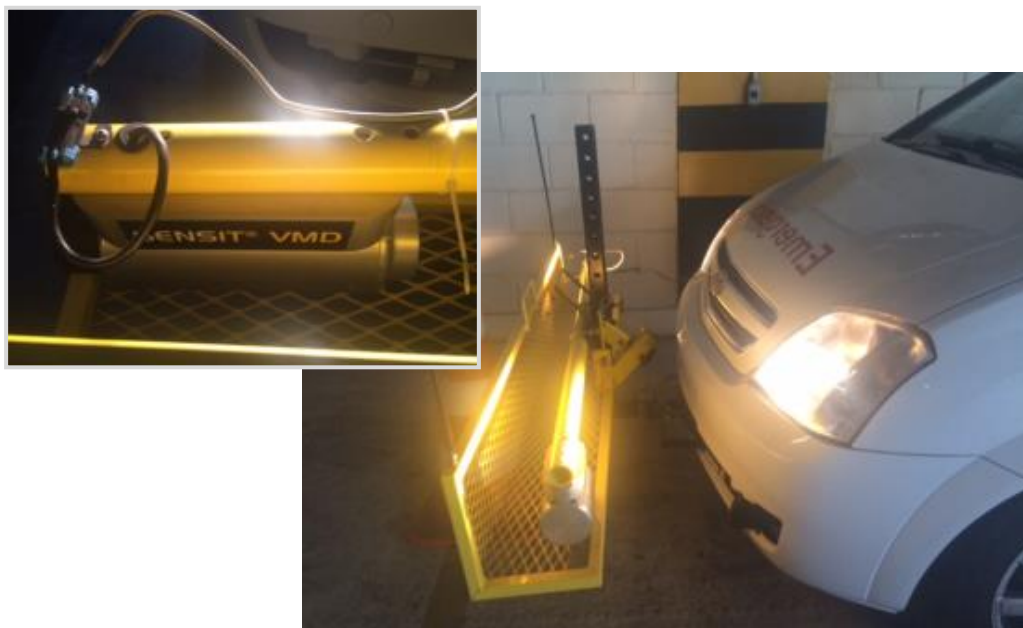
Figura 7.5.8.6-2: Sensor SENSIT® VMD instalado no veículo usado para patrulhar as redes de gás.
