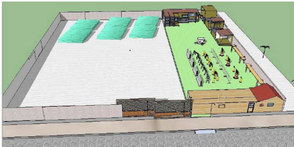
Figura 7.4.1.3-2: Arranjo típico de área de apoio para construção de gasoduto. Fonte: COMGAS.
