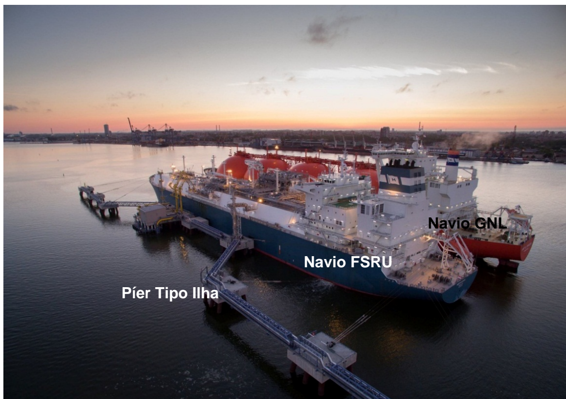
Figura 7.2.2-1: Exemplo de transposição de GNL entre os navios pelo tipo “ ship-to-ship ” em píer offshore , tipo ilha com amarração em dolphins .
