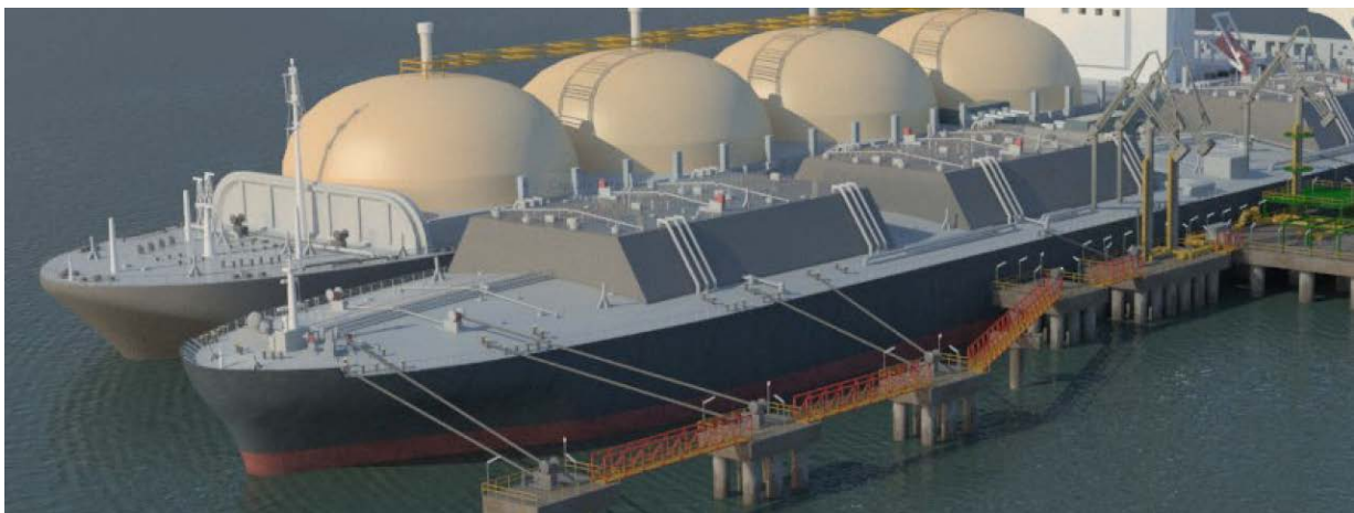
Figura 7.2.3-1: Figura ilustrativa de píer tipo ilha com dolphins de amarração/atracação. Navio FSRU atracado a contra bordo do navio carregador de GNL (LNGC).
