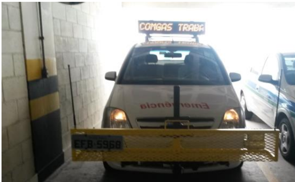
Figura 7.5.8.6-1: Veículo “Cheira-Cheira” com sensor SENSIT® VMD para detecção de vazamentos de GN.
