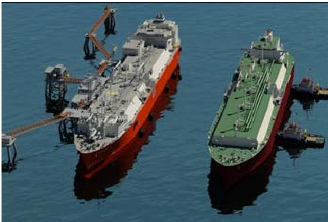
Figura 7.5.1-3: Ilustração de conceito da operação de atracação do LNGC ao FSRU no Terminal GNL.
