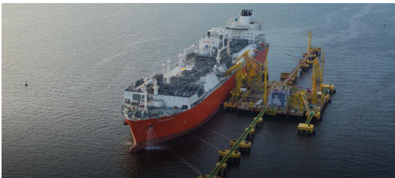
Figura 5. Exemplo de FSRU em operação, atracado em terminal de GNL com píer tipo ilha. Fonte: Excelerateenergy.com
