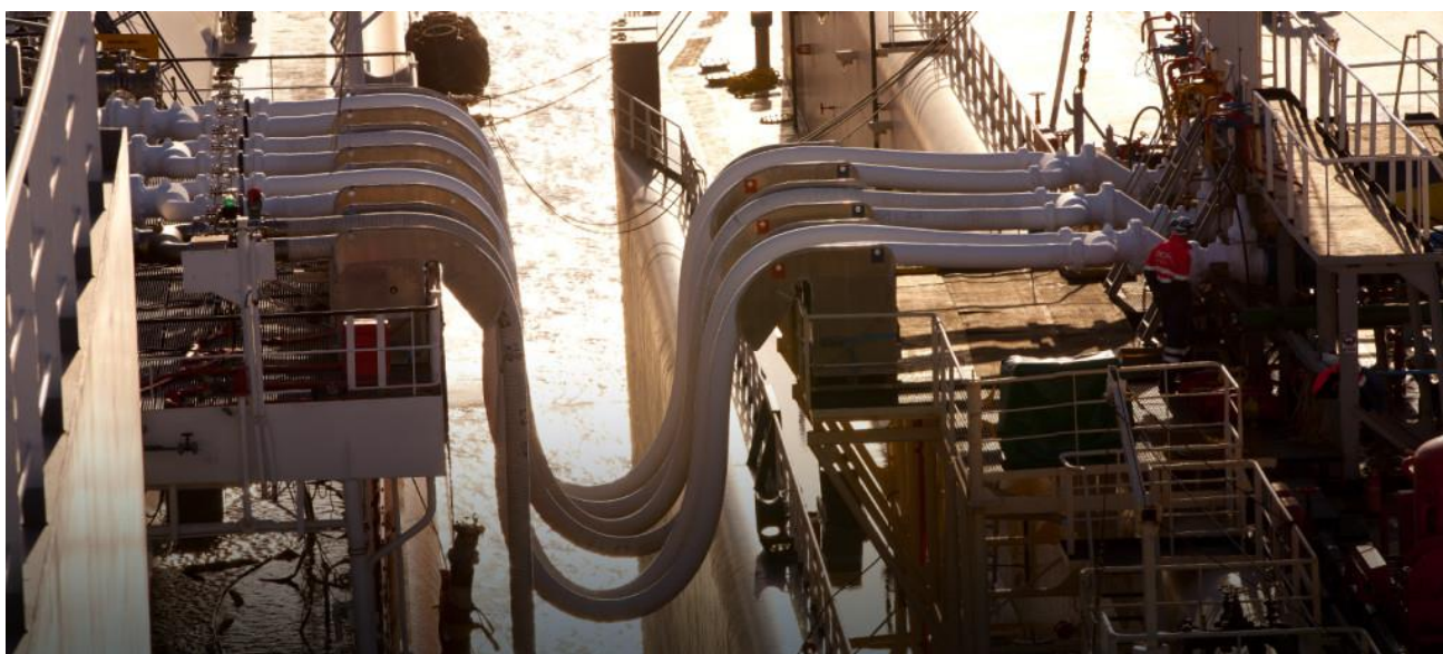
Figura 6. Conexão ship-to-ship para transbordo de GNL entre o LNGC e o FSRU. Fonte: Exceleerateenergy.com.
