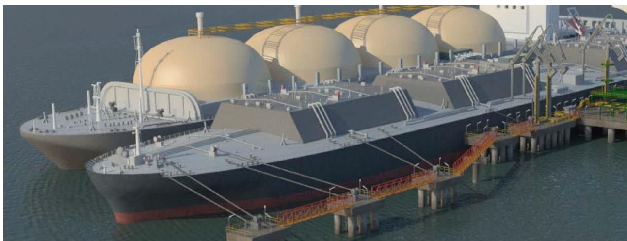
Figura 2. Figura ilustrativa de píer tipo ilha com dolphins de amarração/atracação. Navio FSRU atracado a contra bordo do navio carregador de GNL (LNGC).
