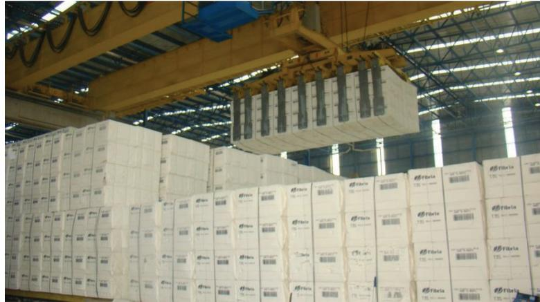
**Figura 71 – Movimentação dos fardos de celulose através da ponte rolante.**
