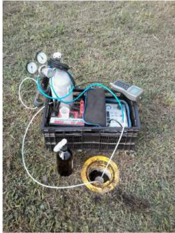
Foto 3.3 – Processo de coleta da amostra de água subterrânea PM-26.
