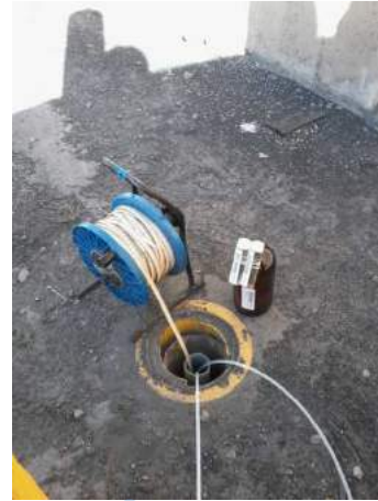
Foto 3.4 – Processo de coleta da amostra de água subterrânea PM-11.
