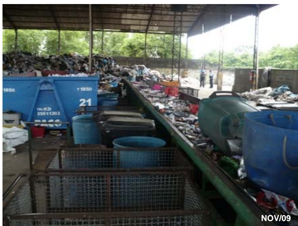
Figura 2: Vista parcial da esteira de triagem no interior da usina.
