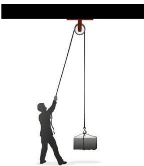
As roldanas, também chamadas de polias, são tipos de rodas utilizados em máquinas para direcionar a força feita sobre determinados objetos por meio de fios, cordas ou cabos. Elas são utilizadas na construção civil, na composição de motores, aparelhos de academia etc. E geralmente é utilizada para erguer objetos pesados, e a força feita para tal tarefa corresponde exatamente ao peso do objeto elevado.
