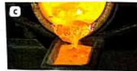
► Metal em estado líquido sendo colocado em formas para ser moldado.
