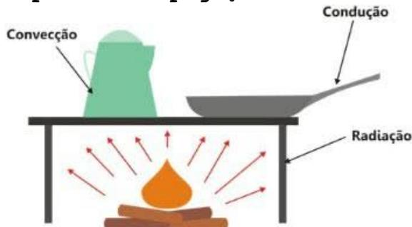
Ilustração das três formas de transmissão de calor
