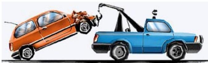
Fig. 3- No guincho dos veículos de socorro a acidentes graves existe uma roldana que ajuda a içar o carro acidentado.
