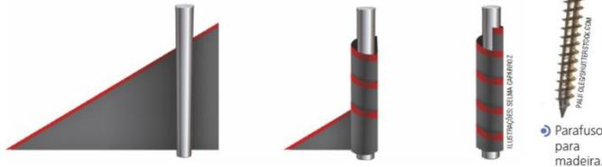
O espiral de um parafuso, também pode ser utilizado para outros fins, como o Parafuso de Arquimedes ou bomba de parafuso, que é uma máquina utilizada para transferir líquidos de um local mais baixo até um ponto mais elevado. Um plano inclinado reto, nunca conseguiria realizar essa ação.
