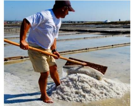
• A evaporação é um dos processos usados para obter o sal de cozinha. Nas salinas, parte da água do mar é represada em tanques largos e rasos. O sol aquece essa água, fazendo-a evaporar. Ao final da evaporação, resta nos tanques apenas o sal. (Chavel-CE, 2016).
