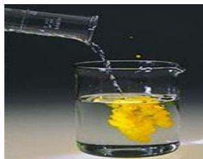
Reação de precipitação entre as soluções aquosas que contêm íons de chumbo e de iodeto de potássio.
