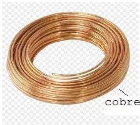
O cobre é sólido em condição ambiente e usado em fios para condução de corrente elétrica.
