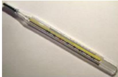
No Brasil, todas as medições são feitas através da Escala Termométrica Celsius ( $^{\circ}\text{C}$ ), onde o termômetro é dividido em 100 partes iguais, ou seja, sua variação de temperatura vai de  $0^{\circ}\text{C}$  a  $100^{\circ}\text{C}$ .
