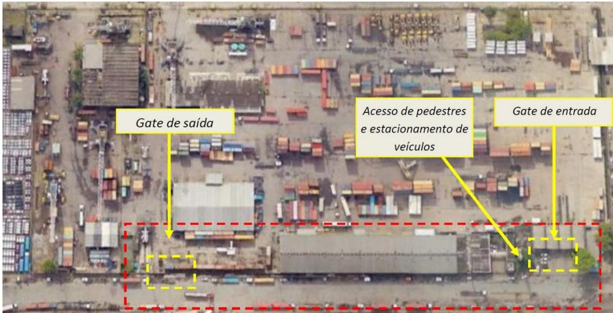
*Figura 4 – Imagem obtida do EIV onde pode-se observar os acessos de entrada e saída do terminal.*
