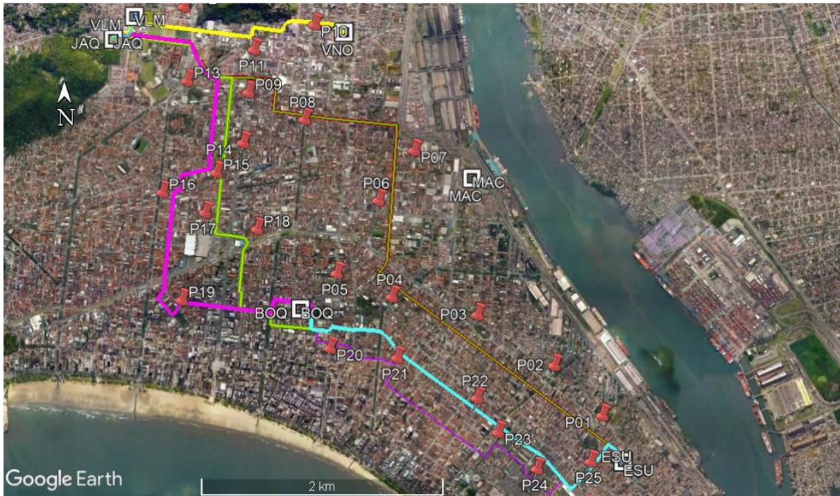
Figura 4 – Imagem extraída do EIV em que mostra os pontos de medições de ruídos e vibrações.
