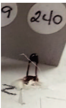
Figura 4 – Sensor de velocidade fabricado a partir de termistor.
