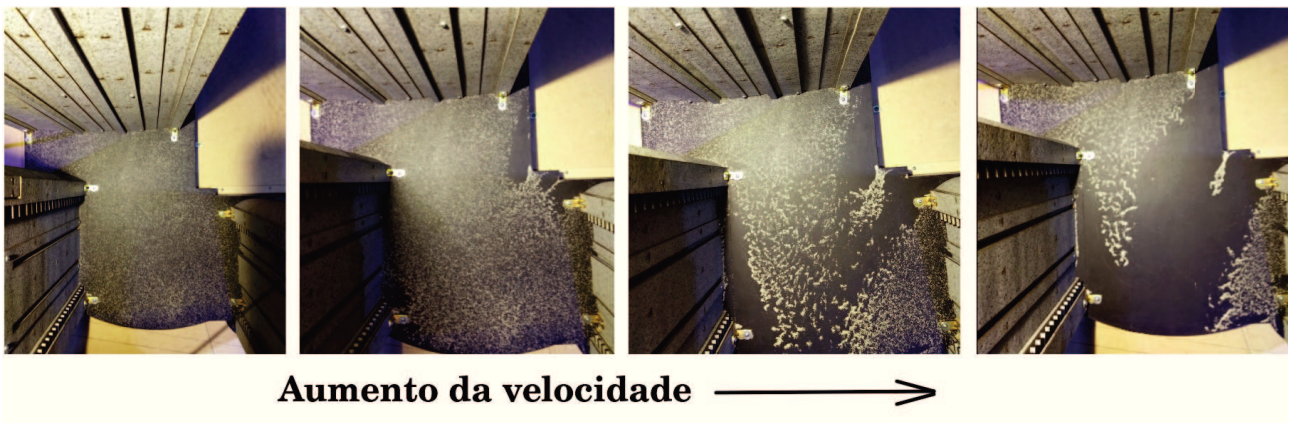
Figura 8 – Erosão observada para ensaio com vento sudeste. As figuras, da esquerda à direita, representam os padrões observados com o aumento da velocidade no túnel de vento.
