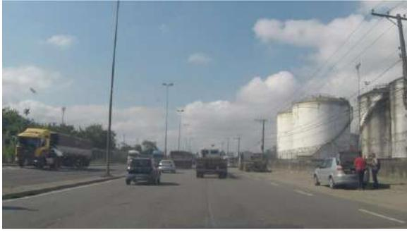
**Foto 2.2-10.** | Ao longo da Av. Augusto Barata, a pavimentação se alterna em trechos de CBUQ e paralelepípedos, entretanto suas características geométricas se mantêm, com desenvolvimento em pista dupla e duas faixas de rolamento por sentido.
