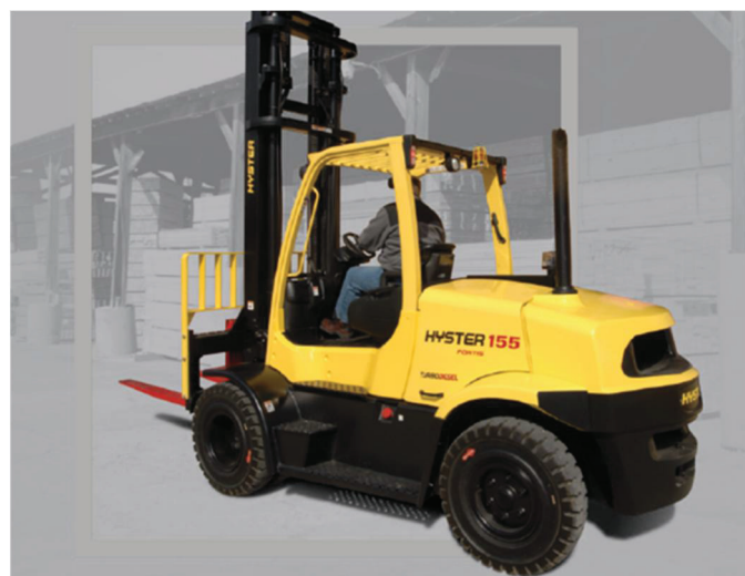
Figura 64 – Modelo de empilhadeira equipada com garras verticais.
