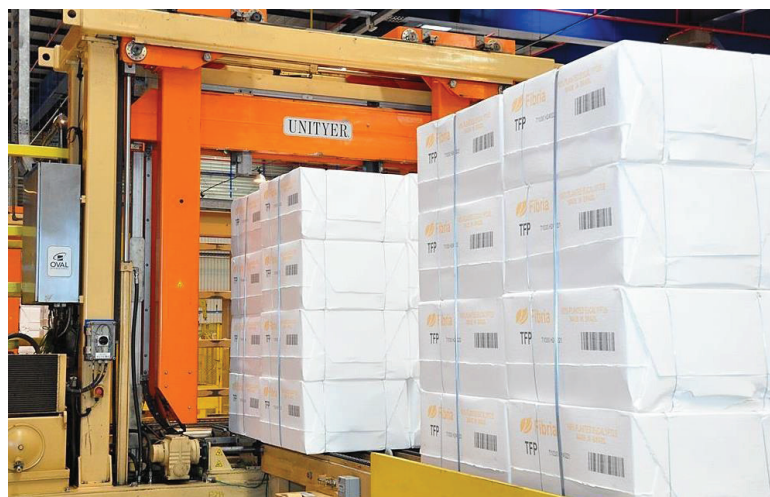
Figura 58 – Seção de agrupamento dos fardos de celulose formando uma unidade de transporte de 2.000 kg.
