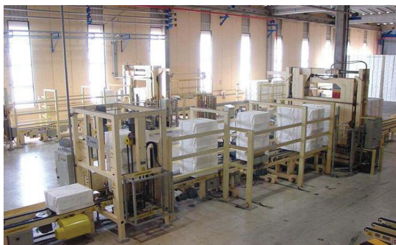
Figura 57 – Seção de prensagem e embalagem das folhas de celulose em fardos de 250 kg.
