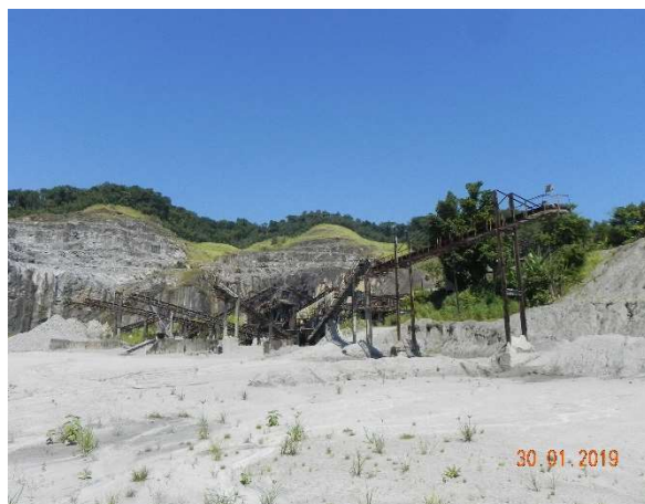
Foto 18: Vista frontal da linha de britagem e beneficiamento do material extraído da lava.
