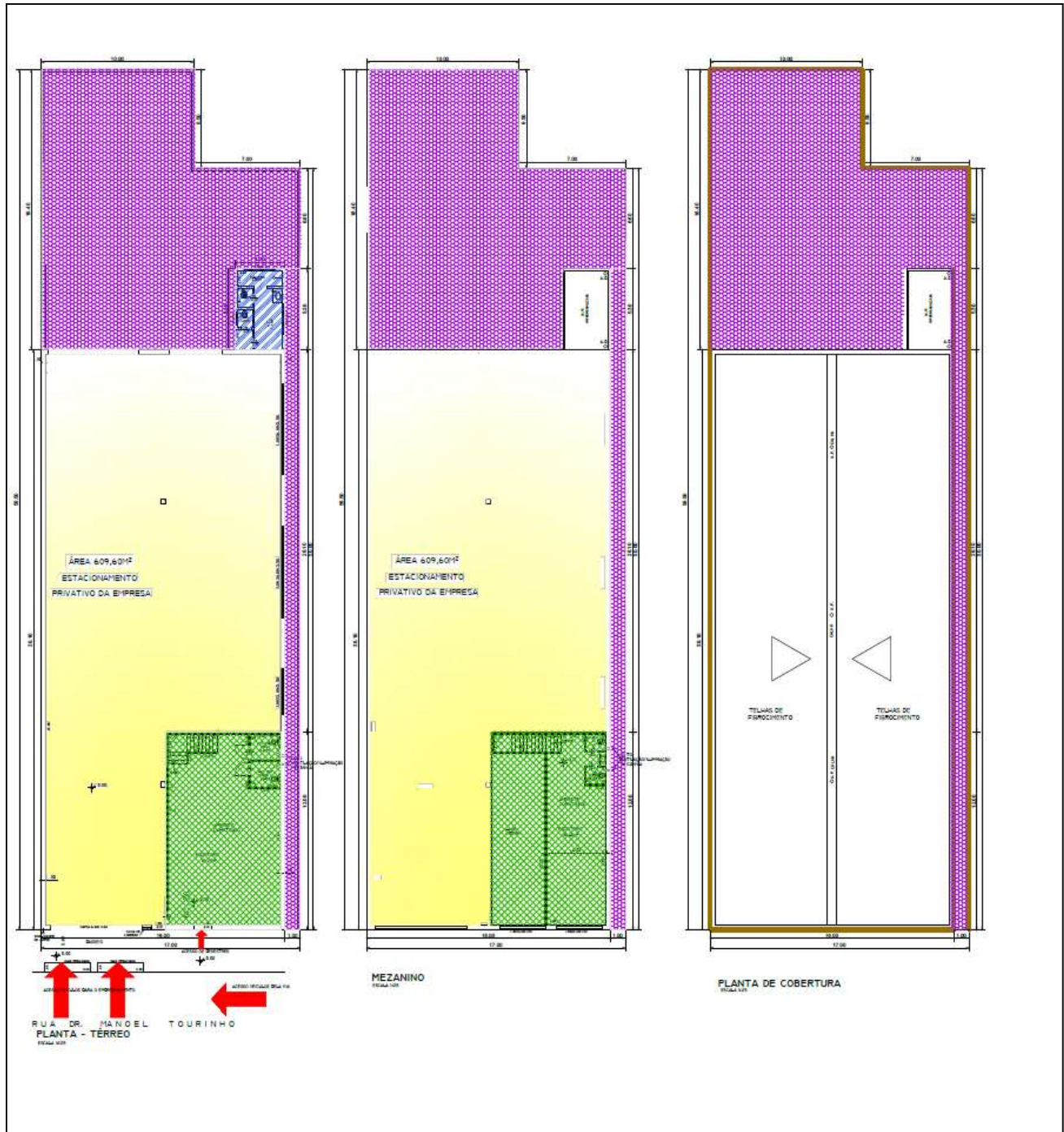
Figura 07- Planta de compartimentação interna
