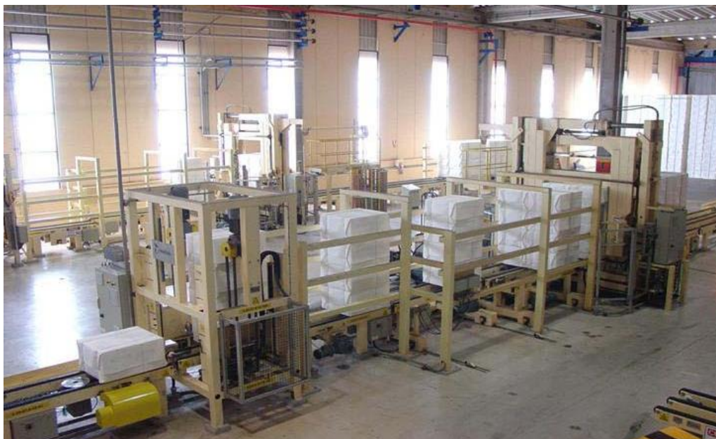
Figura 19 – Seção de prensagem e embalagem das folhas de celulose em fardos de 250 kg. Fonte: Poyry, 2016.
