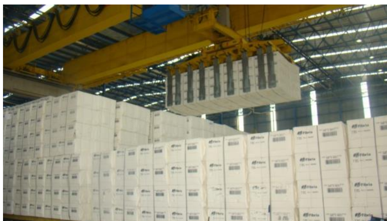
Figura 27 – Movimentação dos fardos de celulose através da ponte rolante. Fonte: Poyry, 2016.
