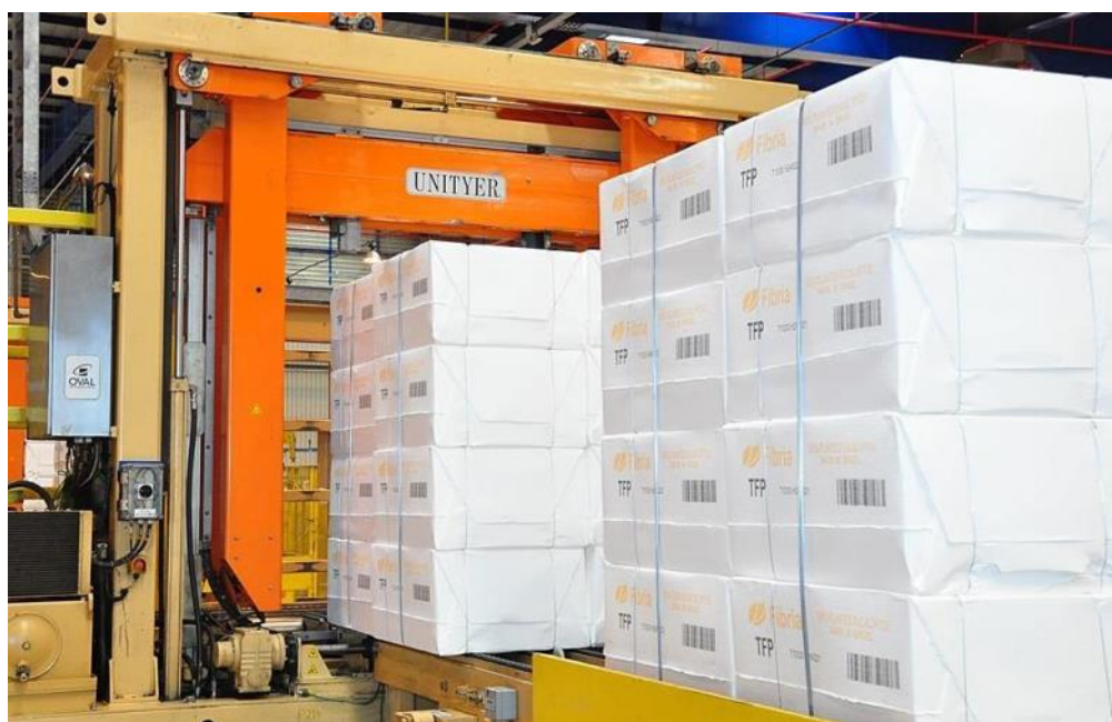
Figura 20 – Seção de agrupamento dos fardos de celulose formando uma unidade de transporte de 2.000 kg. Fonte: Poyry, 2016.
