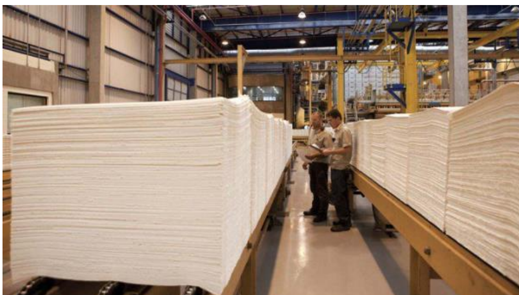
Figura 18 – Folhas de celulose secas e cortadas. Fonte: Poyry, 2016.
