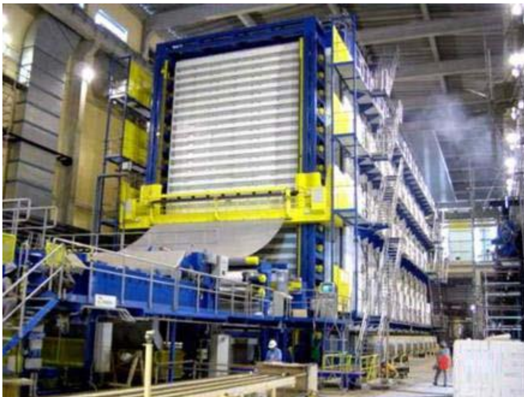
Figura 17 – Visão geral da máquina de secagem de polpa de celulose. Fonte: Poyry, 2016.
