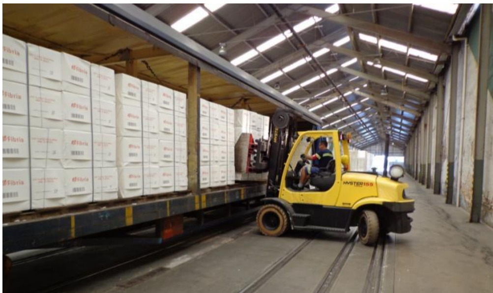
Figura 21 – Vagão de fardos de celulose sendo descarregados. Fonte: Poyry, 2016.
