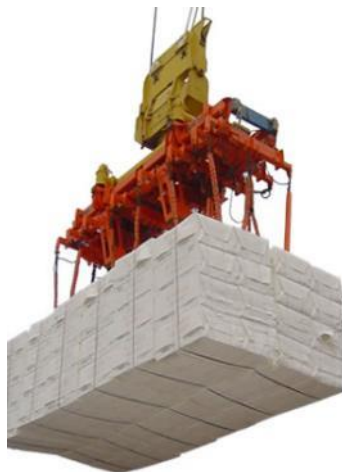
Figura 28 – Carregamento do navio utilizando guindastes ( Jib Crane ). Fonte: Poyry, 2016.
