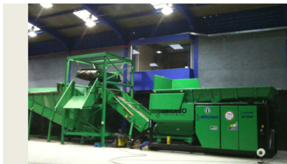
Foto 05: Exemplo de Abridor de Sacos e Extrator Eletromagnético.
