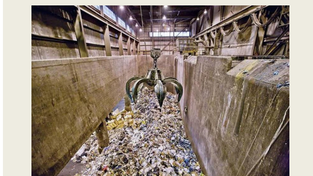
Foto 03: Exemplo de Fosso de Recebimento com garra hidráulica.
