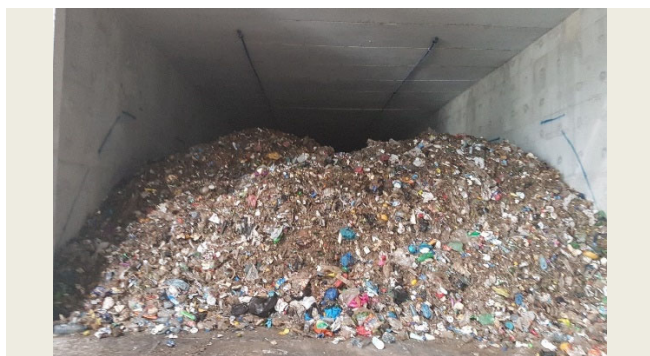
Foto 09: Exemplo de Bioestabilizador com CDR.
