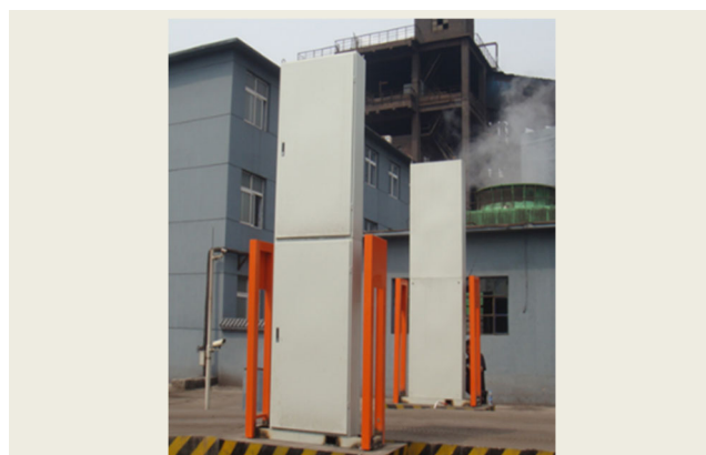
Foto 02: Exemplo de detector de material radioativo.
