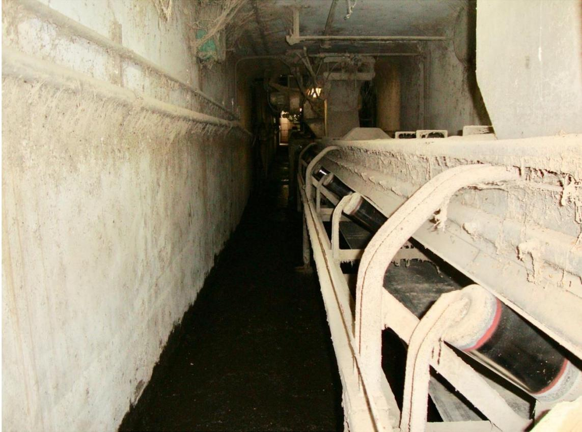
Foto 6.9 - Alinhamento do Transportador de Correias do Túnel Silos 4 e 5
