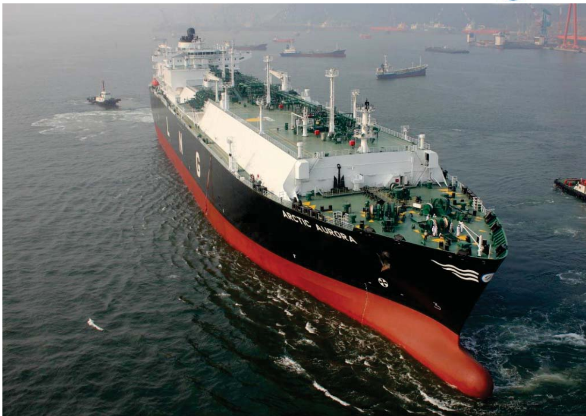
Figura 2.3 – Exemplo de Navio Metaneiro (LNGC) com Tanques Tipo Membrana
