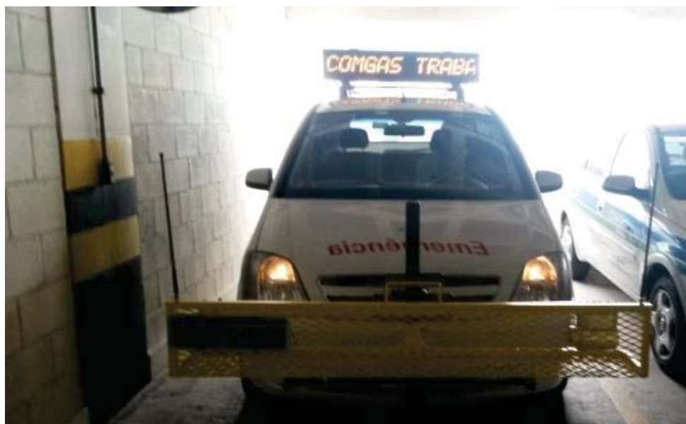
Figura 2.21 – Veículo “Cheira-Cheira” com sensor SENSIT® VMD para detecção de vazamentos de GN
