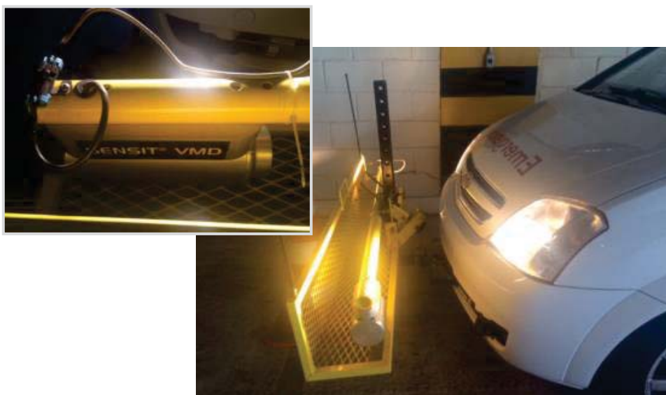
Figura 2.22 – Sensor SENSIT® VMD instalado no veículo usado para patrulhar as redes de gás
