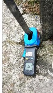
**Poste n°8** – estrutura em concreto com captor no topo e descida em cordoalha de cobre até barra de terra
