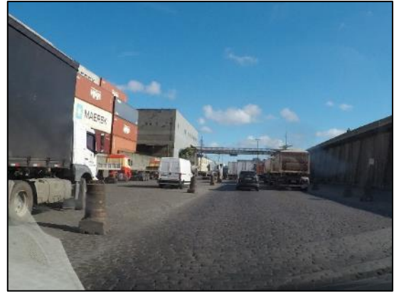
Foto 2.12: Trecho da Avenida Eduardo Pereira Guinle, após a área STS11. Nota-se, pela imagem, que as áreas destinadas ao enfileiramento dos veículos de carga com destino ao terminal encontram-se definidas utilizando-se de cones, ou seja, equipamentos de sinalização provisória.
