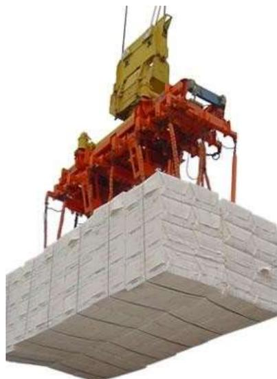
**Figura 12 – Carregamento do navio utilizando guindastes (*Jib Crane*).**
