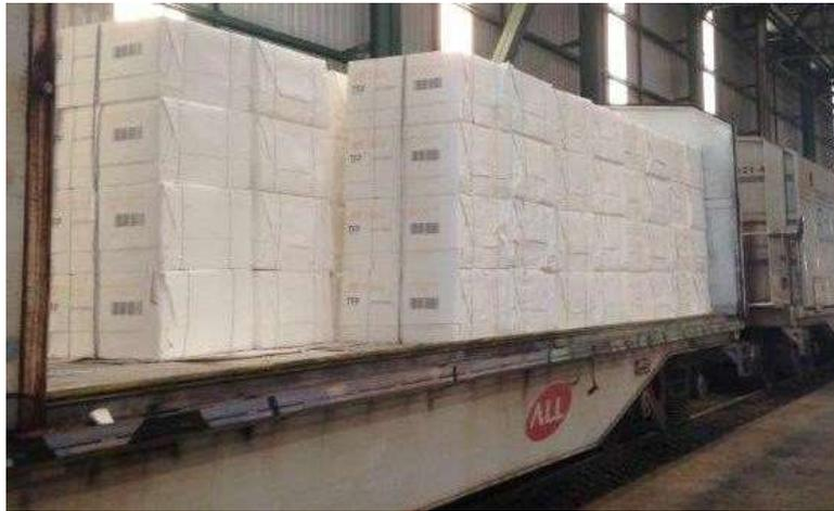
**Figura 3 – Modelo de vagão de transporte de fardos de celulose.**
