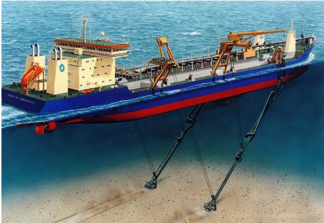
Figura 9.1.11.2.3-2: Dragagem do tipo Trailing Suction Hopper Dredger (TSHD). Fonte: Jan de Nul.
