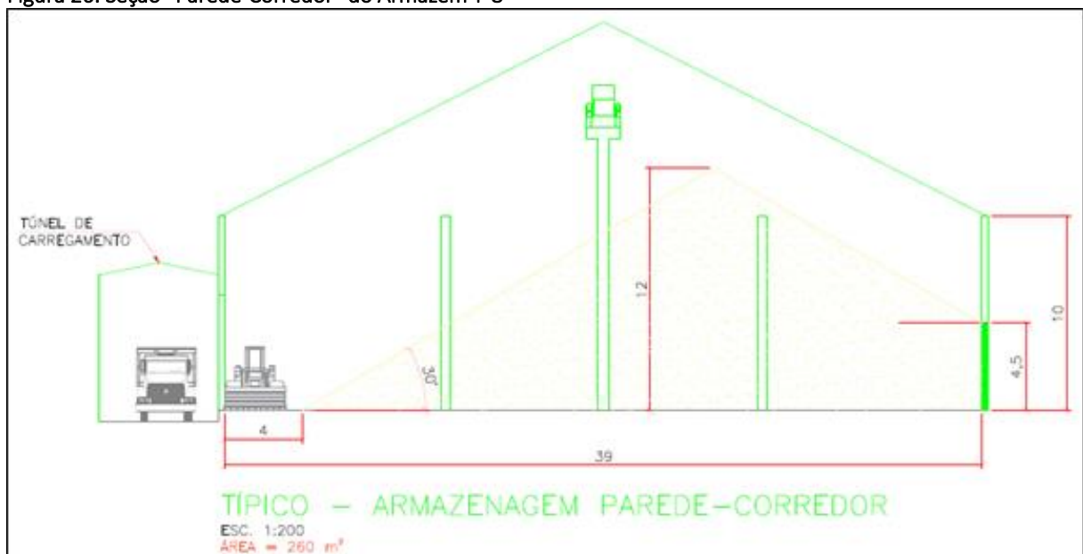
Figura 26: Seção “Parede-Corredor” do Armazém T-8
