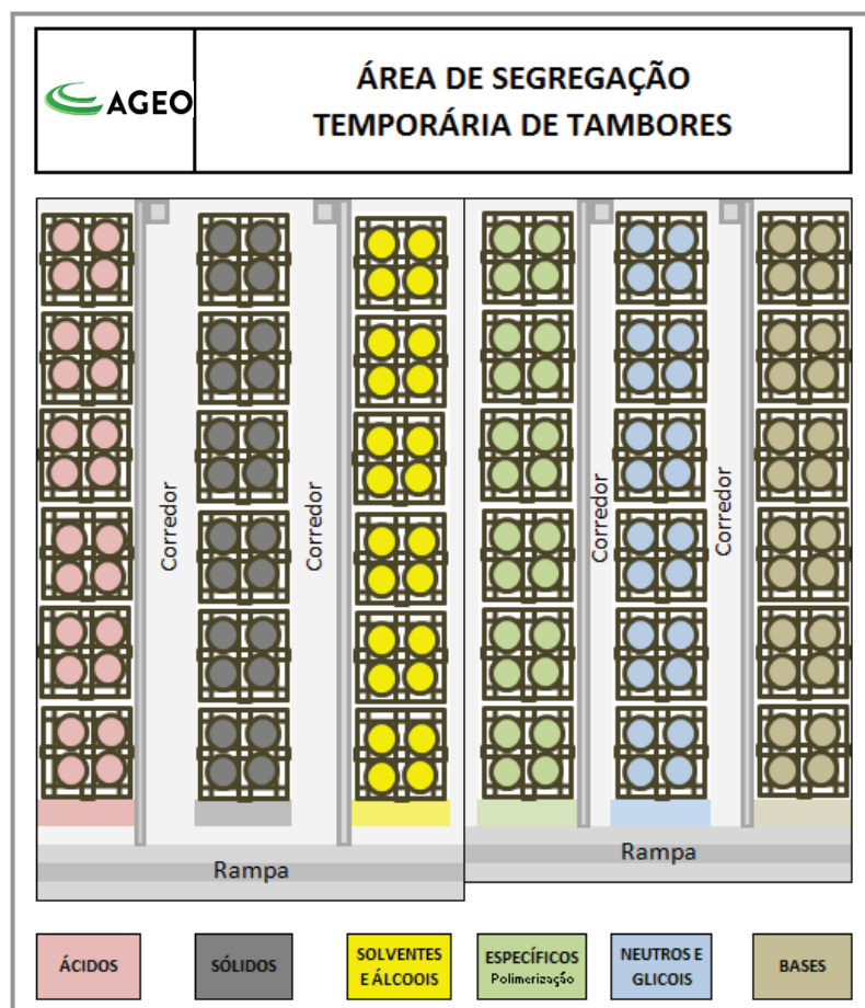
Figura 10 - Layout geral da ASTT e suas respectivas fileiras
